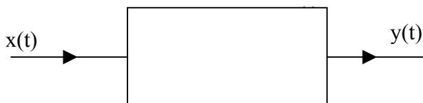
$x(t)$  est un signal sinusoïdal dont on fait varier la fréquence, on mesure  $y(t)$  lorsque le système est stabilisé.  $y(t)$  est un signal de même fréquence que  $x(t)$
