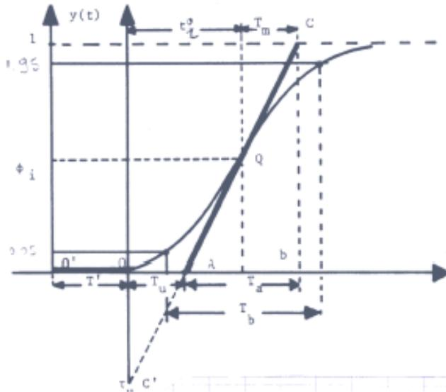
La tangente au point d'inflexion coupe l'axe des abscisses en  $T_u$ , l'asymptote (régime permanent  $y(\infty)=1$ ) en  $t_i + T_m$  et l'axe des ordonnées en  $\tau_u$ . On a les relations :
